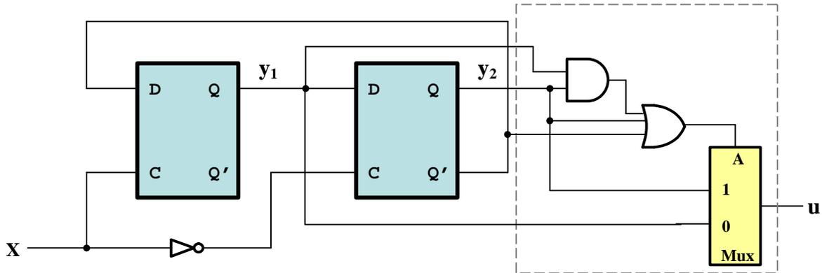
**DOMANDA N.1 (PUNTI 2)** – Utilizzando le espressioni caratteristiche del latch CD in forma SP si scrivano le espressioni minime di  $Y_1$ ,  $Y_2$  e  $u$
