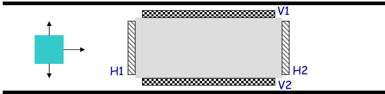
A causa di possibili variazioni nel posizionamento del pezzo meccanico durante l'intera fase di transito nella regione indicata in figura si desidera attivare, mediante l'uscita A di una RSA, gli ugelli che immettono vernice nell'area indicata in grigio esclusivamente se il pezzo meccanico è completamente all'interno dell'area indicata in grigio.
