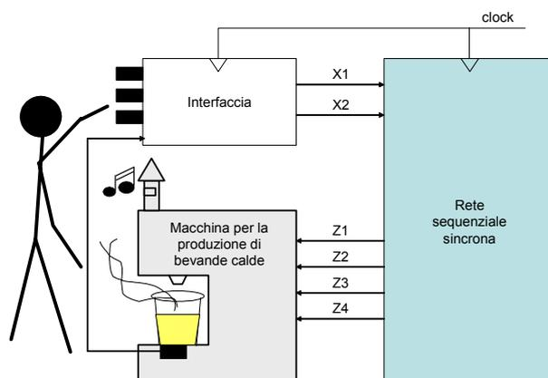
Ogni azione elementare impegna la macchina per **due secondi** durante i quali la configurazione di comando deve essere tenuta costante.
