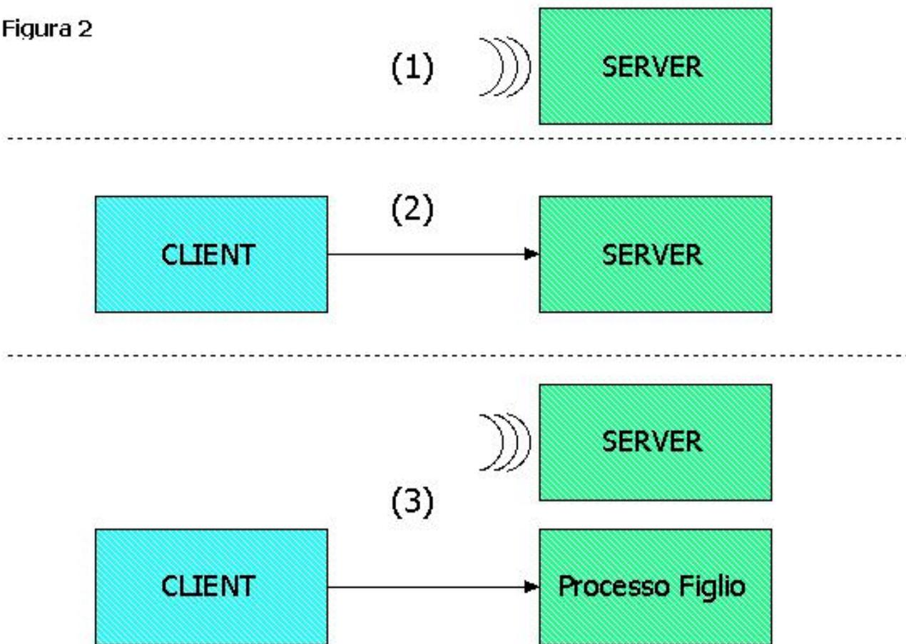
La **figura 2** mostra le tre fasi con cui avviene l'accesso del client al servizio.
